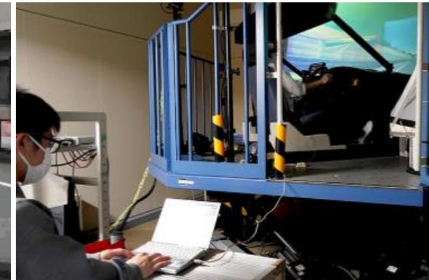
ドライビングシミュレーターによるドライバの運転特性計測（栗谷川幸代 教授）
