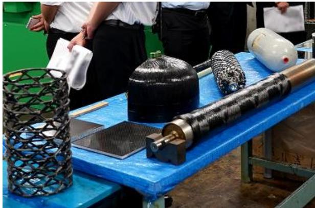
円筒形CFRP製グリッド補強FCV用高圧水素タンクの開発 (坂田憲泰 教授)
