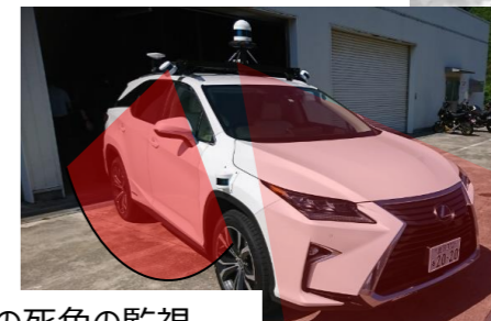
車両前方の監視 (非機械式PCSEL-LiDAR)
